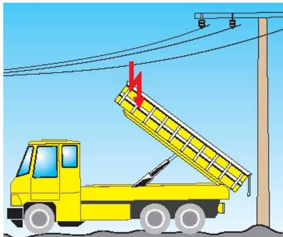
Abb. 7 Gefahren bei Arbeiten in der Nähe von Freileitungen
